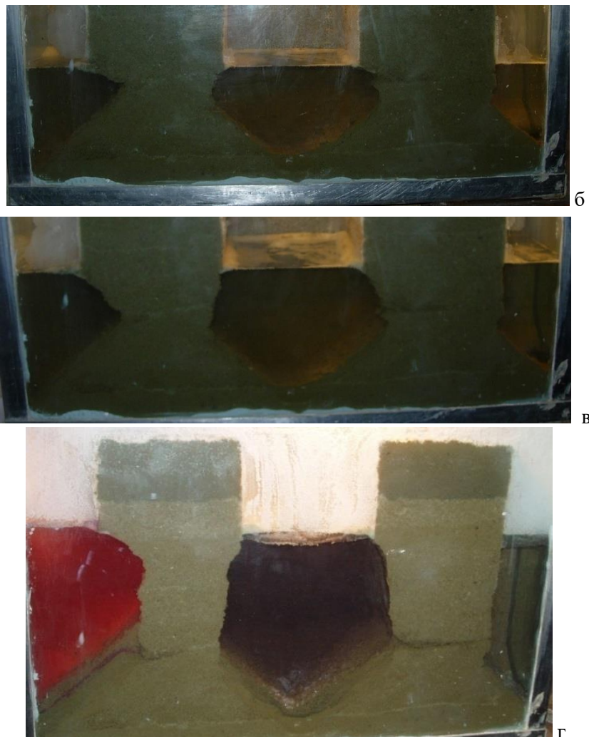
Рис. 2. Результати експериментального моделювання розчинення ціликів у агресивному розсолі – від початкового розчинення (а), формування ніш вилуговування (б), зростання асиметрії ніш вилуговування (інтенсивне розчинення ціликів камери з водопритоком, сповільнене розчинення у камері № 3 та ледь помітне розчинення у камері № 3) – (в), до передобвального стану (г)
