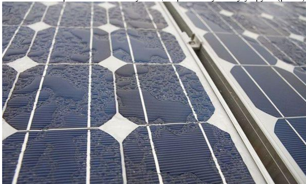
Рис. 5. Ефект концентрування зливових опадів на поверхні сонячних панелей, що полягає у накопиченні розрізнених крапель та їхньому акумулюванні у різні за розмірами та
