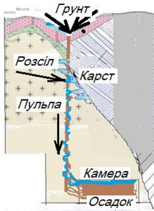
Рис. 4. Схема формування гідросуміші
