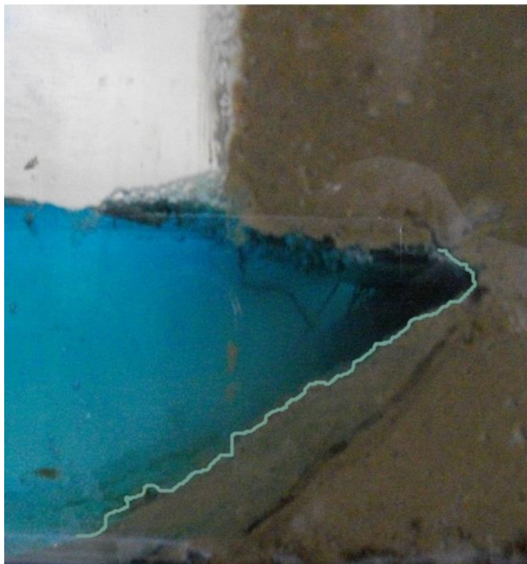
Рис. 6. Експериментальна модель утворення ніш вилуговування у міжкамерних ціликах
