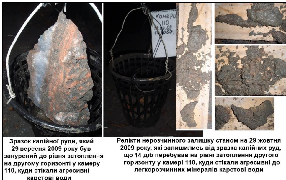
Рис. 7. Результати польового експериментального моделювання у камері 110 другого горизонту рудника № 2 проведеного із 29 вересня до 13 жовтня 2009 року з визначення швидкостей розчинення легкорозчинних мінералів у реальних умовах агресивним розсолом, його насичення та переходу у рівноважний стан із вміщуючими соляними мінералами міжкамерних ціликів за лічені тижні, при цьому розчиняються практично усі легкорозчинні соляні мінерали, у тому числі галіт, а релікти галітового каркасу та вкраплень каїніту і лангбейніту, зберігаються за умови ізолювання від агресивного розчину суцільним прошарком глини
