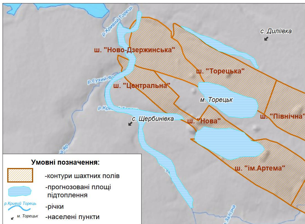
Рис. 3. Схема розвитку площ підтоплення за результатами прогнозування на територіях, прилеглих до шахт ДП «Торецьквугілля»
